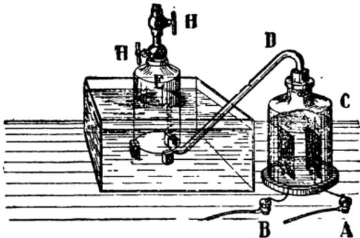
В пробку сосуда *C* вставлена изогнутая стеклянная трубка *D*; она подведена под банку *E* и, может быть, напомнит вам отводную трубку, присоединенную к трубке с железными стружками в том опыте с тиглем, который мы проделывали в прошлый раз.
