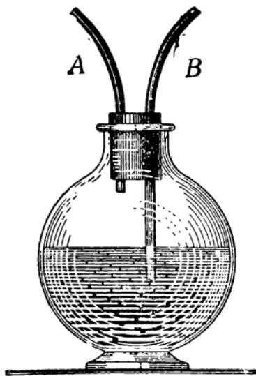
прибор, который при всей своей простоте позволяет сделать изящный и убедительный опыт; этот прибор заставит воздух двигаться только в одном направлении, а не обратно, когда я буду дышать через среднюю отводную трубку. В первой банке налита простая вода, во второй — известковая. Входя в первую склянку, воздух будет проходить ко мне в рот и легкие, давая мне возможность дышать, а на
